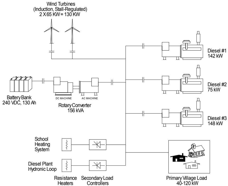
FIGURE 1. WIND-DIESEL SYSTEM ARCHITECTURE FOR WALES, ALASKA
