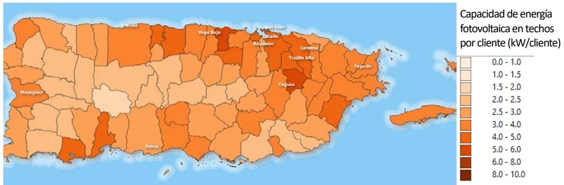
**Figura 19. Capacidad de energía fotovoltaica en techos del año 2050 por cliente para el Escenario 3 con carga de Estimación media (3 LM)**
