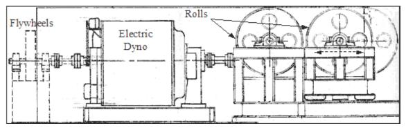
Figure A-1. Chassis dynamometer schematic
