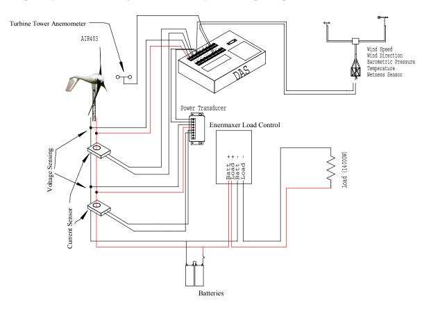
FIGURE 4. TURBINE CONFIGURATION FOR POWER PERFORMANCE TEST
