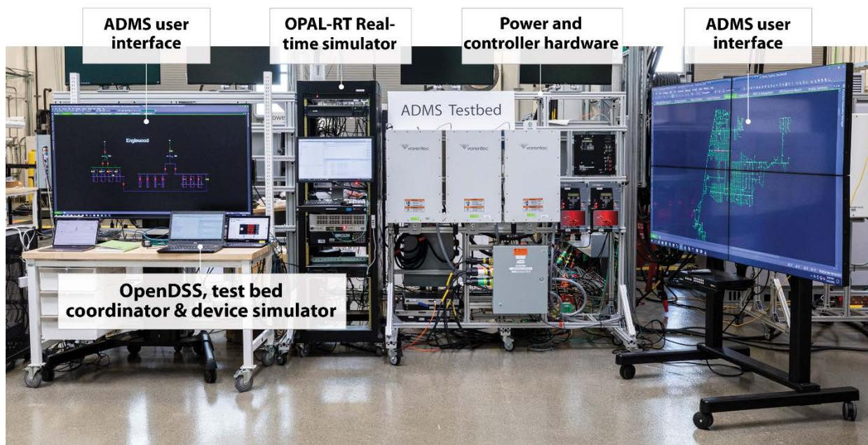
**Figure A-2. Photograph of ADMS Test Bed setup**
