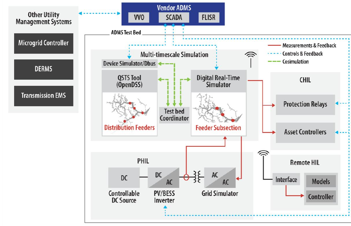
**Figure A-1. ADMS Test Bed capability**
